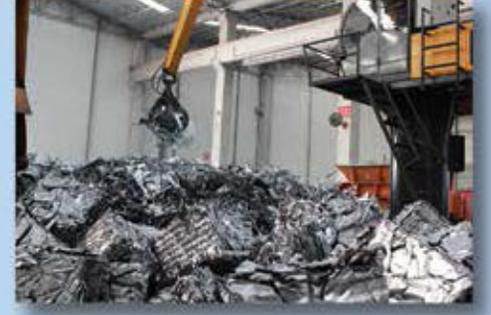
Firmamızda Ana ve Yan Sanayilerden gelen, DKP, sac, demir talaşı, alüminyum, kağıt , tahta vb. hurda malzemeler konteynerlerden boşaltıldıktan sonra, cinslerine göre ayrıştırılmaktadır. Ayrıştırılma işlemi yapılan malzemeler iş makineleri ile otomatik preslere yüklenecek paket haline getirilmektedir. Paketleme operasyonu tamamlanan hurdalar yeniden işlenmek üzere ilgili firmalara gönderilmektedir.
